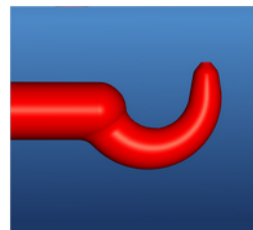
Optimale Anguss-Geometrie, gut verrundet
