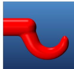
Optimale Anguss-Geometrie, gut verrundet
