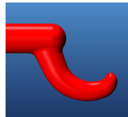
Optimale Anguss-Geometrie, gut verrundet
